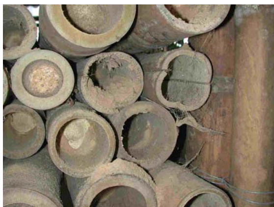
Foto 2: Ataque biótico (Insectos) y ataque Abiótico (rajada), destrucción total de la Guadua, por insectos xilófagos, como el Dinoderus minutus y otras especies.
